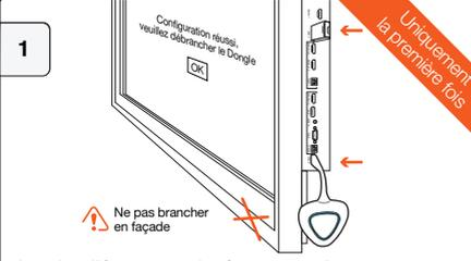
Apparez l'émetteur et le récepteur en les connectant au port Android situé sur le côté de votre écran tactile.
