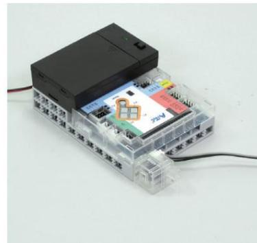
**3** Branche la batterie sur le connecteur **Power** de ton Studuino et ton buzzer sur **A4**.
