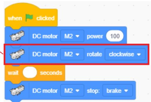
Place la roue gauche de ta voiture (M1) sur ● et la roue droite (M2) sur ★. Si ton programme est correct, ta voiture devrait arrêter sa roue droite (M2) sur la ligne ★ !
