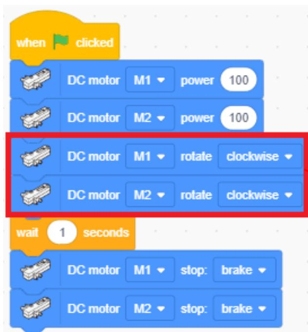
Ces blocs font tourner M1 et M2 dans le sens des aiguilles d'une montre !
