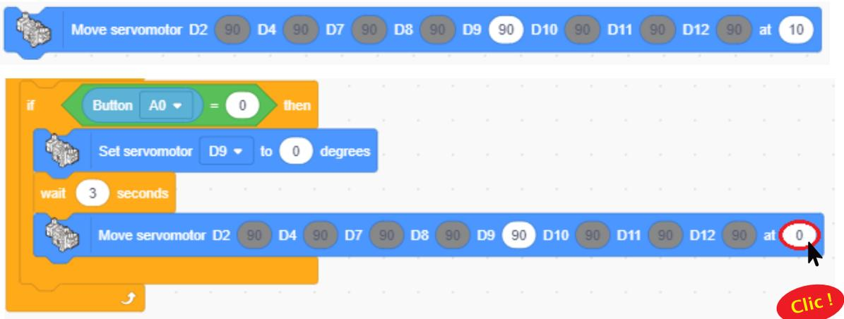
Tu peux régler la vitesse d'un servomoteur de 0 à 20 !
