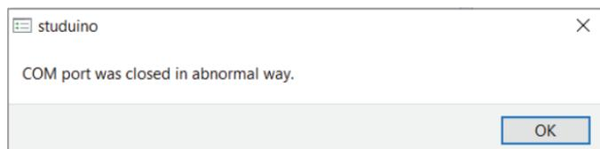
Débrancher le câble USB interrompra la connexion avec ton ordinateur et ce message s'affichera.
