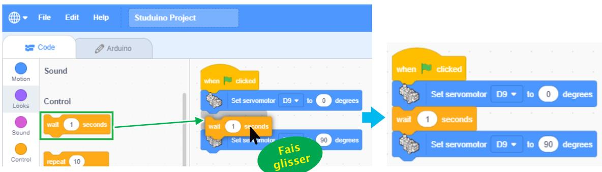
6 Faisons en sorte que ton lanceur garde le bloc quelques instants en remplaçant le nombre dans le bloc
