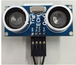
Capteur à ultrasons Le côté métallique de la prise femelle doit être orienté vers le haut.
