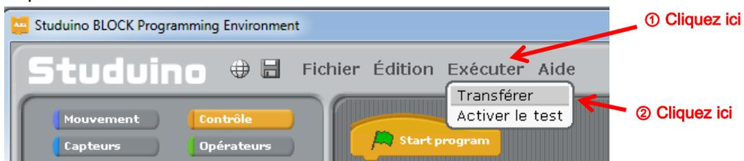
Si le message suivant apparaît et disparaît par la suite, cela signifie que le programme a été transféré avec succès au circuit. À la suite du transfert de données, la LED du circuit clignotera automatiquement à deux reprises après que l'interrupteur à bouton-poussoir A0 a été enfoncé.
