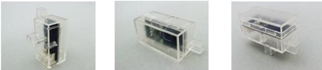
Un accéléromètre fixe dans une direction dans laquelle il indique autre chose que 0 car il détecte une accélération gravitationnelle. Les objets sont attirés vers le sol en raison
