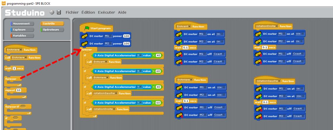
Le programme est maintenant complet. Il utilisera l'accéléromètre pour contrôler la voiture.
